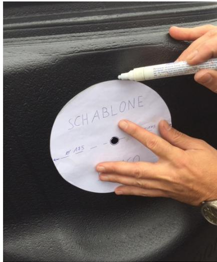
Die Bohrschablone wird am bestehenden Tanküberlauf mittig platziert und der Umfang der Bohrschablone wird markiert (siehe Bild unten)
