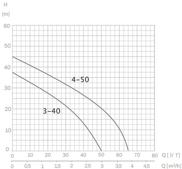
Diese Übersicht basiert auf einer kinematischen Viskosität von 1mm<sup>2</sup>/s und einer Dichte von 1.000kg/m<sup>3</sup>.
