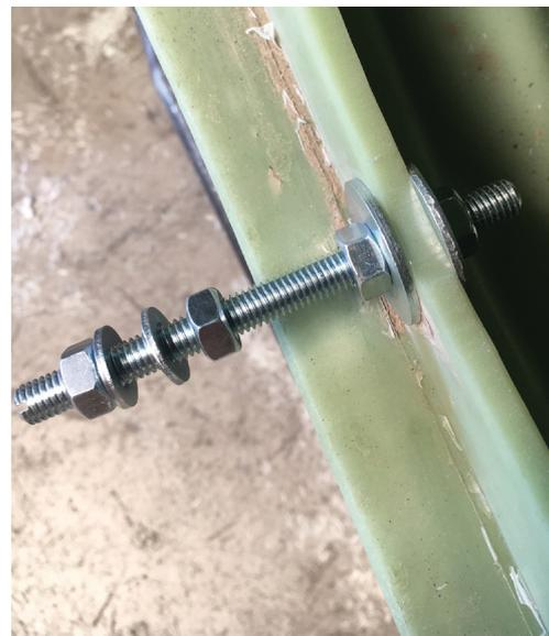
Schritt 2: Muttern und Beilagscheiben von Gewindestift herunterdrehen
