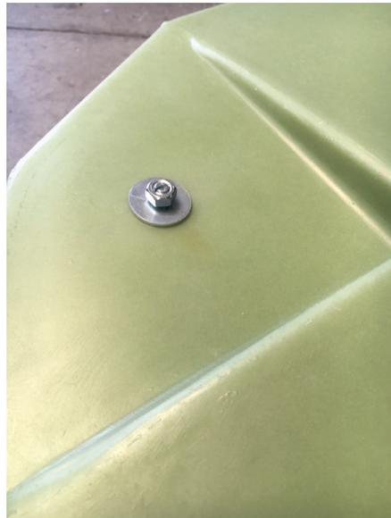
Schritt 8: Gewindestifte mit Beilagscheibe und Mutter verschrauben
