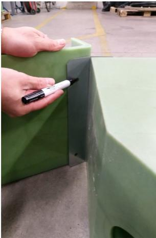
Schritt 4: Es sind die Bohrungen des Befestigungswinkels auf die Flügelemente zu übertragen
