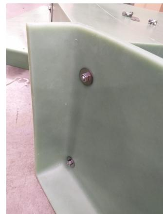
Schritt 7: M8 x 25mm Schrauben mit Beilagscheibe und Mutter fixieren
