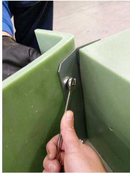
Schritt 8: Festziehen der Schraubenverbindung
