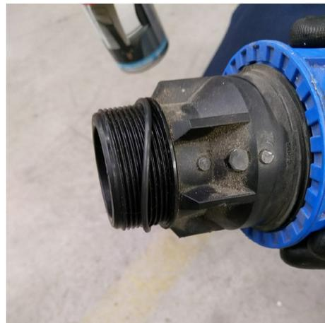
Schritt 14: O-Ring auf die ASKV-Verschraubung schieben
