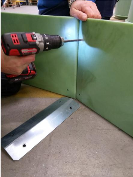
Schritt 19: Markierte Bohrungen mit einem 9mm Bohrer aufbohren
