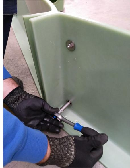
Schritt 20: Flügelemente und Befestigungswinkel bei den 4 Bohrungen mit M8 x 25mm Sechskantschrauben, Beilagscheiben und Muttern fixieren und festziehen
