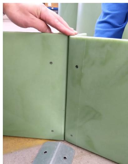
Schritt 18: Befestigungswinkel und Flügelemente an der Kante des Befestigungswinkels ausrichten und die Bohrungen des Befestigungswinkels auf die Flügelemente übertragen
