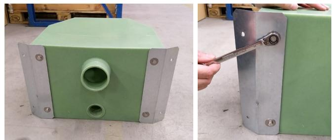
Schritt 2: Befestigungswinkel mit 4 Stk. M8 x16mm Sechskantschrauben und Beilagscheiben befestigen und mit Schraubenschlüssel festziehen
