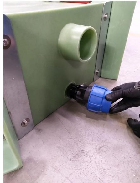
Schritt 16: ASKV-Verschraubung inklusive O-Ring in das vorgefertigte Gewinde schrauben
