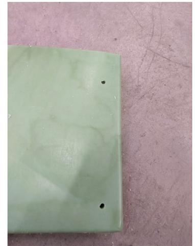
Schritt 5: Die Markierungen mit einem 9mm Bohrer aufbohren
