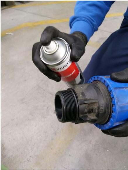
Schritt 15: ASKV-Verschraubung inklusive O-Ring mit Silikon spray einsprühen
