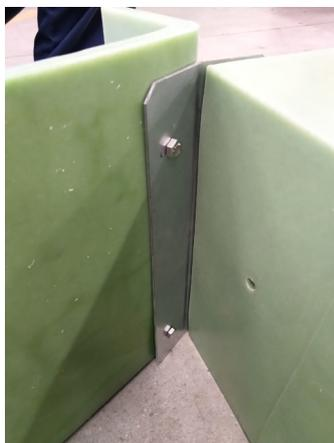
Schritt 6: Sechskantschrauben M8 x 25mm zur Befestigung der Flügelemente durch die Bohrungen schieben
